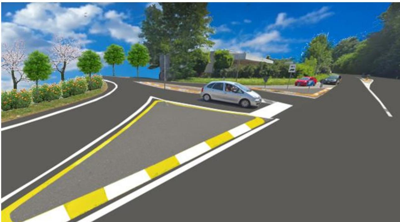
*Ipotesi di progetto con isole spartitraffico*
